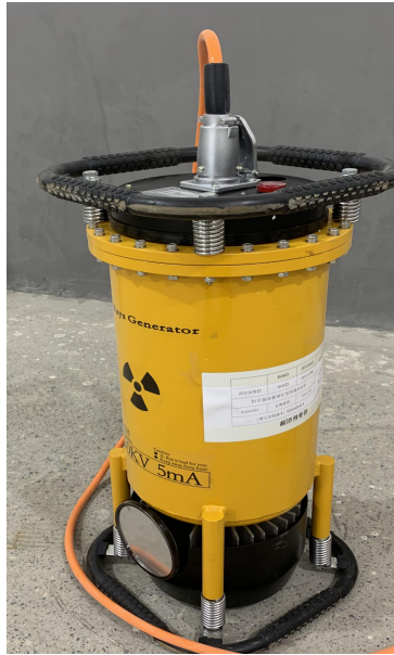
本项目定向 X 射线探伤机 图 2-1 本项目项目探伤机典型探伤工件照片
